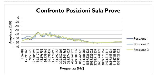
Figura 12 - Funzioni di trasferimento nei punti di misura rispetto alla sorgente sonora.
