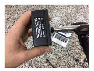
Figura 4 - Calibrazione della catena di misura tramite calibratore Bruel & Kjaer.
