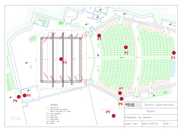
Figura 10 - Pianta del teatro con riportati i punti di misura.
